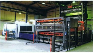
Der Spezialist für Blechtechnik Bickel hat in eine neue Faserlaseranlage investiert und die Abläufe an der Bysprint Fiber automatisiert. Konkret bedeutet dies, dass die Anlage an den Lagerturm Bytower angebunden ist, die Anlage optimal auslastet und eine mannarme Fertigung ermöglicht.
